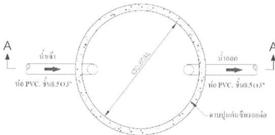
แปลนภาพด้านบนของบ่อตกไขมันแบบวงขอบซีเมนต์
